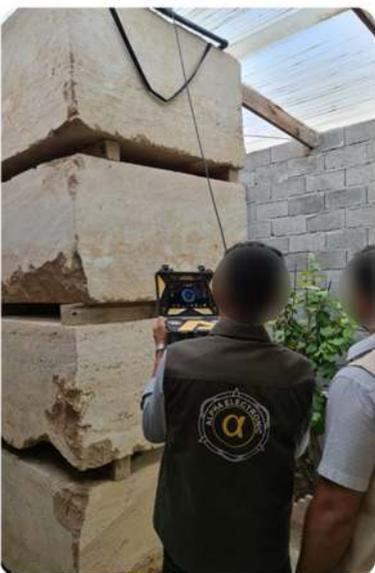
اگر بین لوپ و سنگ هوای آزاد باشد، دستگاه می تواند نفوذ کند یا خیر! این روش تست نیز روش خوب و قابل اطمینانی هست.
