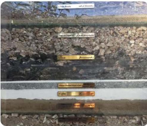
در این روش چندین لایه مختلف از ذرات آهن، طلا، لایه ساروج، لایه آهک، لایه سفال، زغال، آجر پخته، سنگ آهن و ... در مسیر پالس دستگاه قرار می گیرند تا مشخص شود که آیا دستگاه قدرت نفوذ در این لایه ها را بدون کاهش عمق دارد یا خیر!
